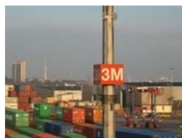
Im Hamburger Hafen: Die Transponder sind an den Lampenmasten befestigt, die Messeinheit befindet sich auf den Van-Carriern (re.) - mit ihnen werden die Container befördert. Mit dem LPR-Systems ist die Position der Transportfahrzeuge exakt bekannt.
